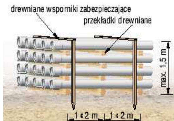
Rys. Składowanie rur na placu budowy
